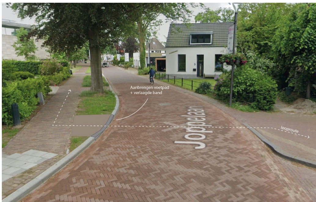
Afbeelding 5.5: Voorstel maatregelen kruispunt Joppelaan - Nijverheidsstraat
