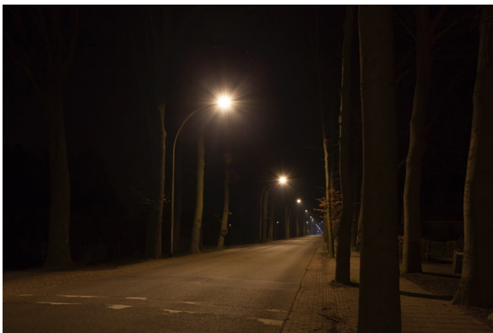
Foto: Joppelaan in Gorssel; licht gelijkmatig over de weg verdeeld zodat er geen zwarte vlekken zijn.
