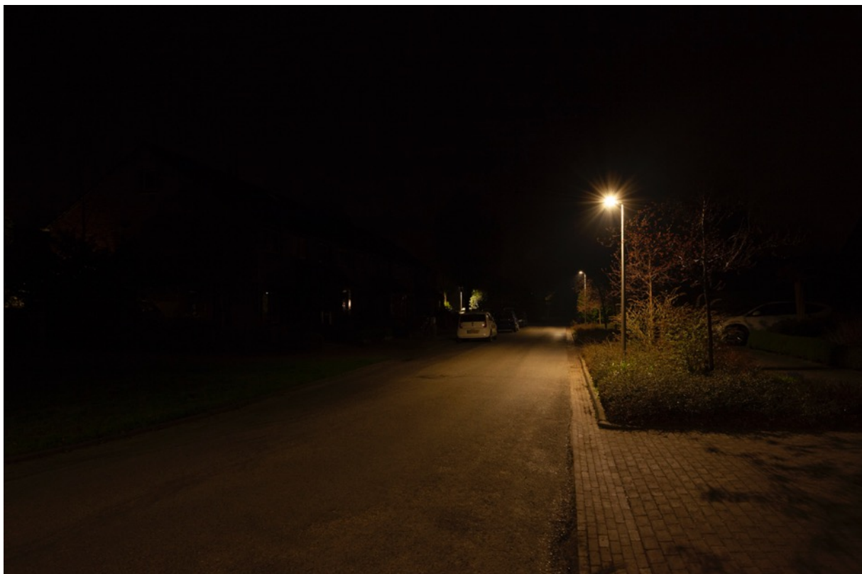
Foto: Reuvekamp in Gorssel. Licht brandt op halve sterkte tussen 00.00 en 05.00 uur. Er is minder verkeer op straat, de ogen zijn gewend aan donker, minder lichthinder en we besparen energie.
