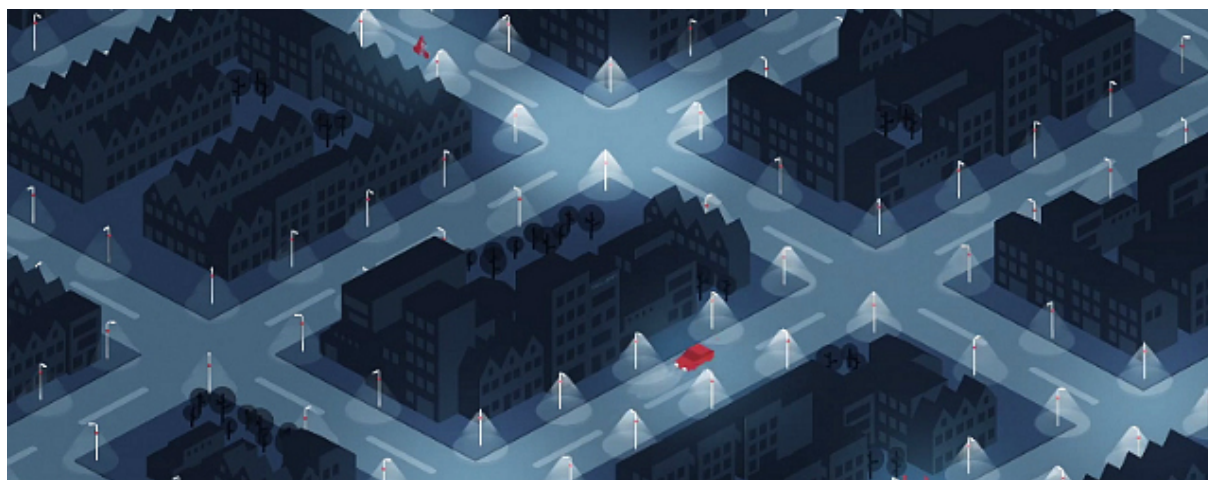
Foto: Detectiesysteem, het licht is aan/brandt feller op die locaties waar verkeerdeelnemers zijn.
