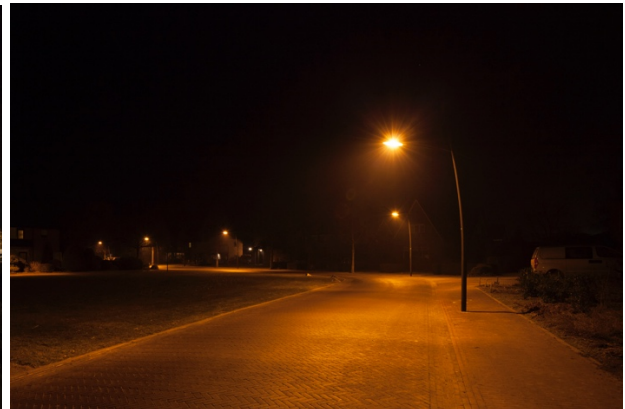
Foto rechts: Bielderweg in Harfsen Verlichting die alle kanten op schijnt. Het lijkt meer licht, maar er is minder licht op de weg.
