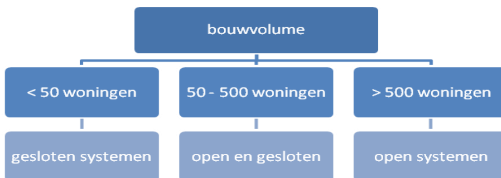
Figuur 2.10 Afwegingsschema toepassing bodemenergietype voor nieuwbouw
