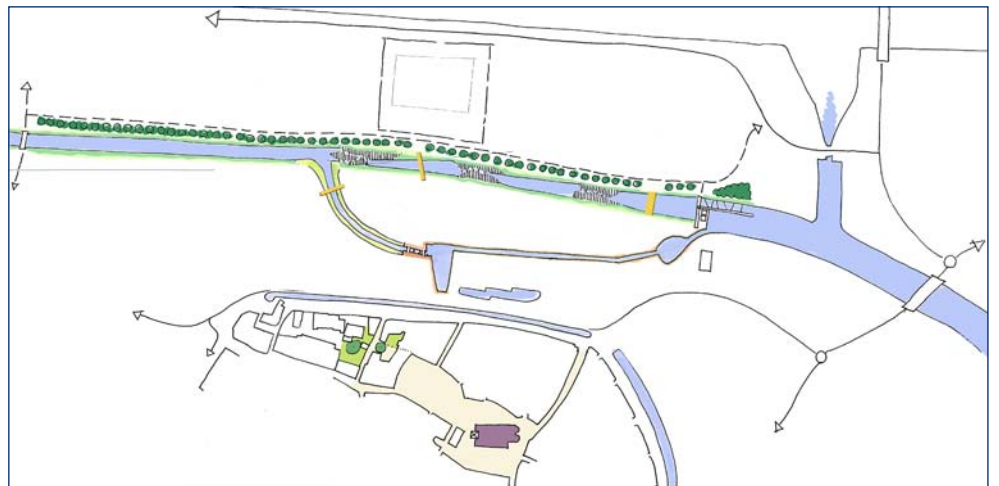
laatste stap: aanleg van een sluis: doorvaart voor de Berkelzomp richting Zutphen
