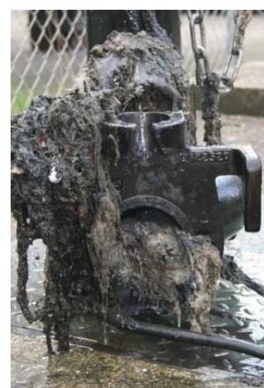
Figuur 19 Verstopte rioolpomp als gevolg van vochtige doekjes
